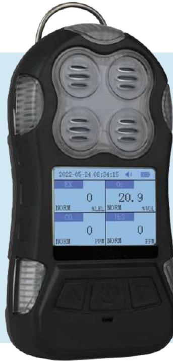
El detector de gases MG-K40 utiliza una avanzada tecnología de circuito integrado a gran escala, una tecnología de diseño inteligente y un detector de gas con tecnología de comunicación híbrida de simulación digital patentada. Utiliza un método de difusión natural para detectar gas y el elemento sensible utiliza sensores de gas de alta calidad. Tiene excelente sensibilidad y repetitividad, uso y mantenimiento convenientes, lo que cumple en gran medida con la seguridad del sitio industrial.
