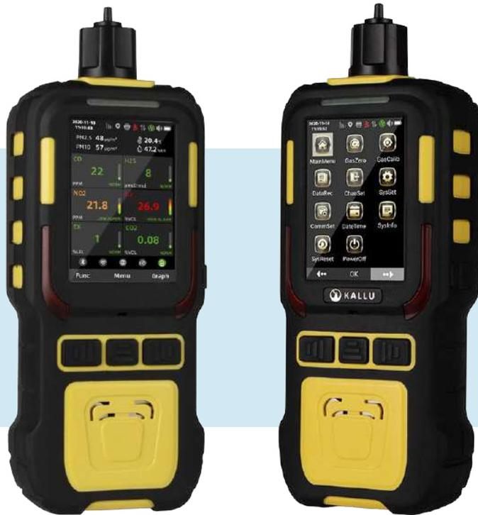
MG-K600M adopta el método integrado de detección de gas de succión de bomba incorporada, que puede detectar 6 tipos de gas al mismo tiempo. Se adopta una bomba de succión de vacío en miniatura importada, con flujo estable, larga vida útil y bajo nivel de ruido.
