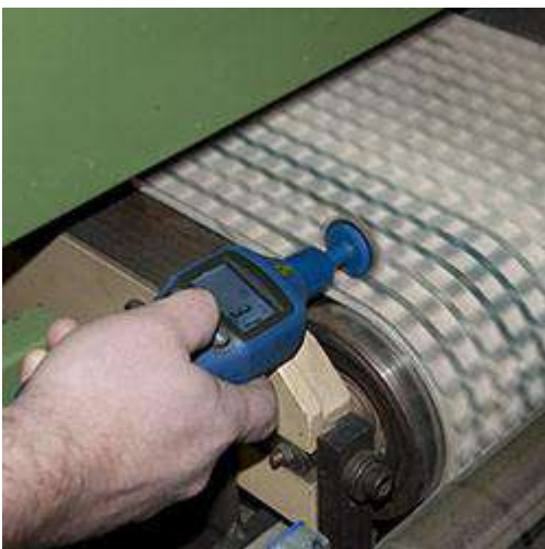
El tacómetro por láser en una medición con contacto en una cinta transportadora.
