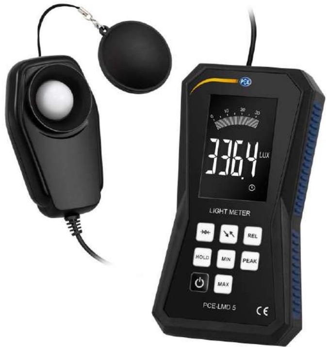
El luxómetro mide en un amplio rango de medición de 0 ... 400 000 lux. El luxómetro utiliza como sensor un fotodiodo de silicio con filtro espectral. Gracias a ello podrá posicionar siempre el sensor del luxómetro de forma correcta. Los valores de medición del luxómetro se muestran en las unidades Lux y Footcandle. Además de visualizarlos de forma numérica dispone de un gráfico de barras.
