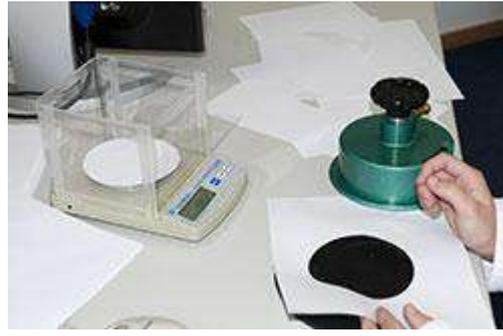
Cortador de muestras circulares: preparación de la muestra
