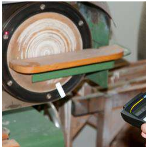
Medición óptica en una lijadora con el tacómetro de mano
