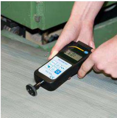
Midiendo con el tacómetro de mano en una cinta transportadora
