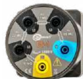
Adaptador CS-1 - simulador de cable
