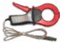
Pinza C-4A (Ø 52 mm) 1000 A AC
