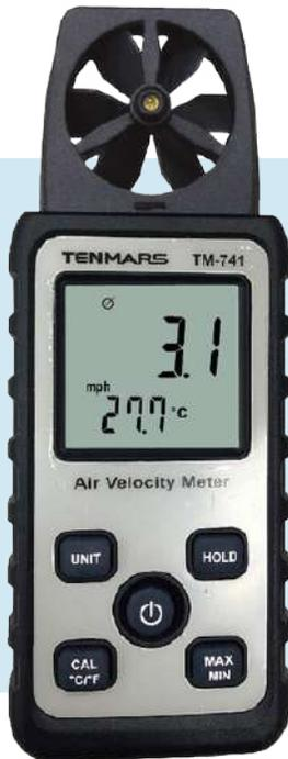
El medidor de velocidad de aire TM-741 es un instrumento compacto muy práctico que mide la velocidad y la temperatura del aire y es ideal para mediciones.
